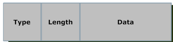
Abbildung 2.6.: BER codiertes Feld (primitiver Datentyp definite-length)
