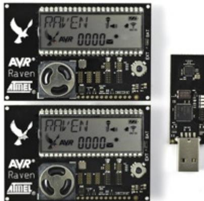
Abbildung 2.4: Atmel AVR RZ Raven Evaluierungskit [AVR RZRaven]
