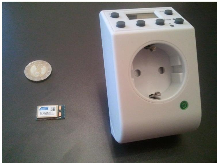
Abbildung 5.1: Tchibo Steckdose mit Zigbit-Modul
